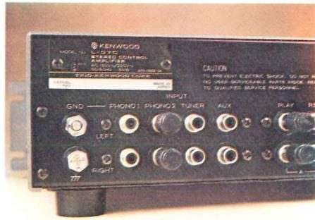
I connettori degli ingressi phono placcati in oro; si notino anche i due morsetti di massa, separati. Sotto; Tra i componenti passivi del controllo di tono, in evidenza i condensatori al tantalio. I transistor sono dotati di alettature insolite per un amplificatore.
